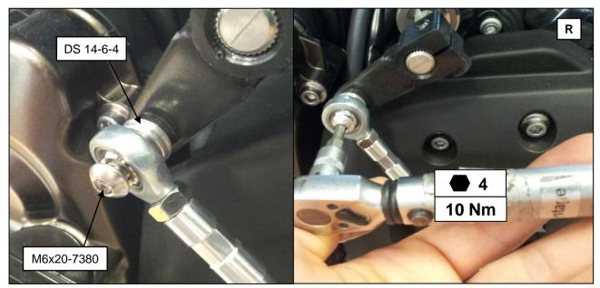
**R:** Montieren Sie die Schaltwelle an den Schaltarm unter Nutzung der ausgewiesenen Schraube und Distanzscheibe. Ziehen Sie die Schrauben **M6x20-7380** fest!
